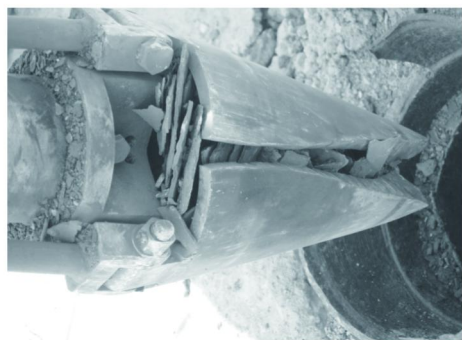
图 2 井内打捞出的铁锈皮
