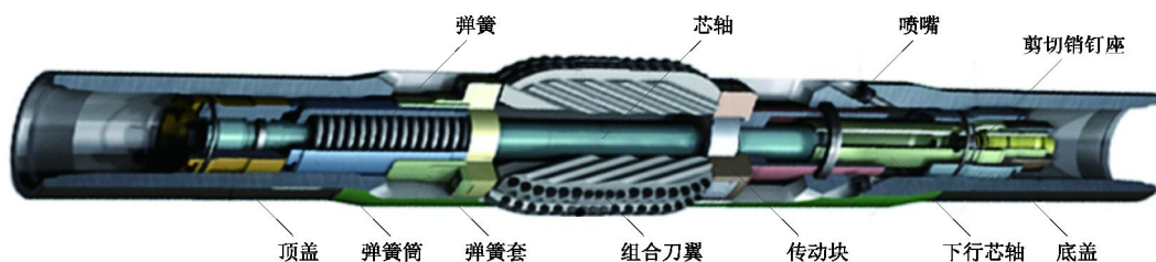
图 1 单球投入式扩眼器结构示意图
