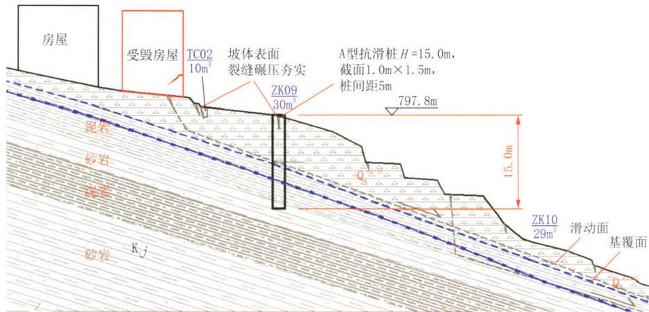
图6 I号滑坡治理方案图(方案一)
