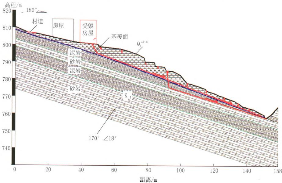
图3 I号滑坡典型工程地质剖面图(I-I'剖面)
