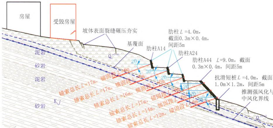
图7 I号滑坡治理方案图(方案二)
