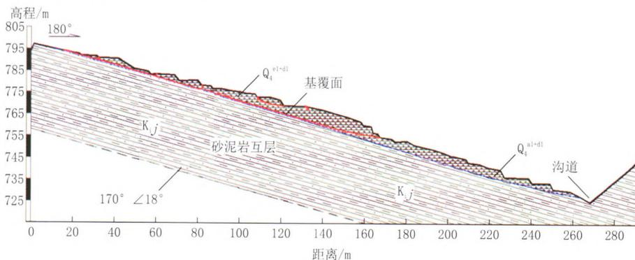
图4 II号滑坡典型工程地质剖面图(III-III'剖面)
