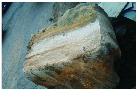
图 5 截齿筒钻提取的柱状岩心沿裂隙分割
