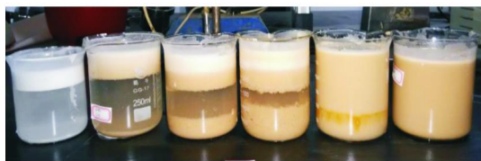
图 2 泥浆静置 12 h 后分层情况
