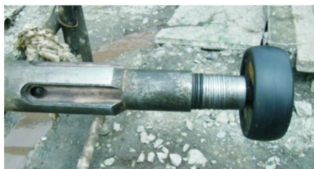
图3 圆盘控制器与 ACT III 仪器连接
