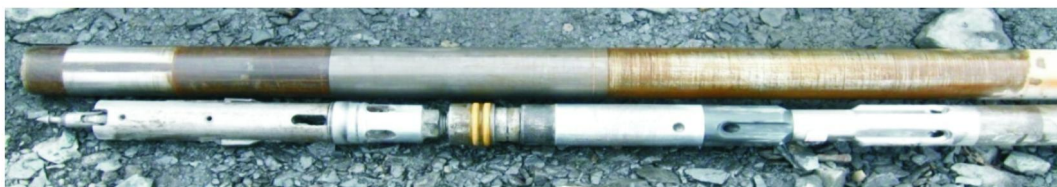
图 2 安装有 Reflex ACT III HQ/HQ3 定向设备的 HQ3 钻具
