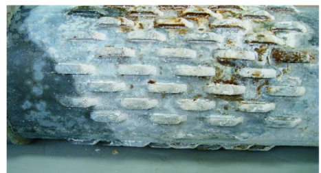
(b) 浸水30 d时腐蚀结垢情况
