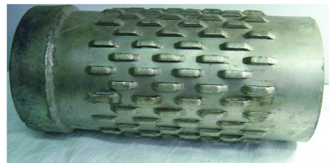
(a) 浸水试验前镀锌过滤管
