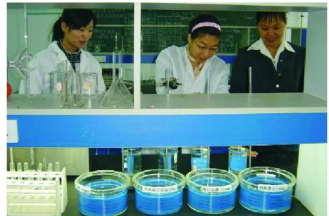
图4 PVC在不同水质中腐蚀结垢试验
