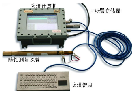
图 1 YHD2-1000(A)型随钻测量系统
