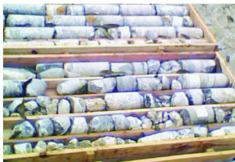
图1 孔深 50.00 ~ 68.38 m 钻遇破碎地层
