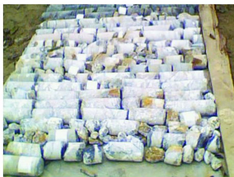
图2 孔深 69.00 ~ 92.40 m 钻遇破碎地层
