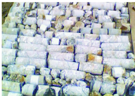
图3 孔深 326.76 ~ 499.44 m 钻遇破碎地层
