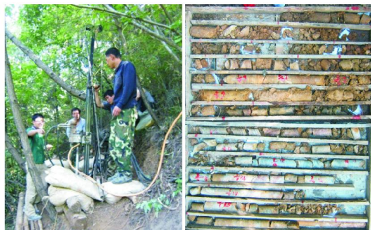
图12 野外施工情形及浅钻获取的岩心样品
