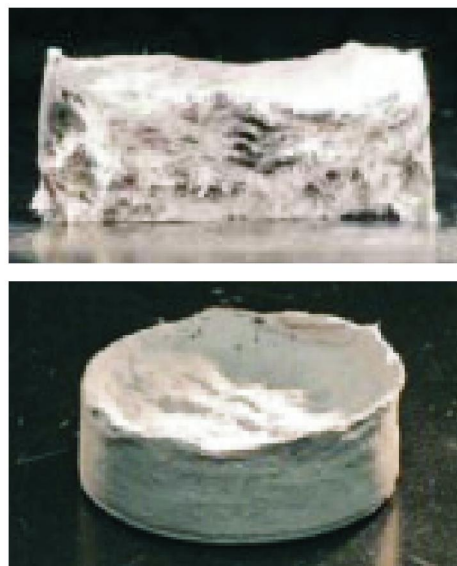
图3 FORM-A-BLOK脱水后形成的堵漏塞
