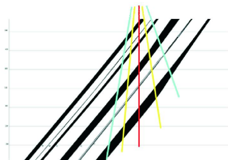
图2 不同入煤井斜角对煤层间距影响示意图
