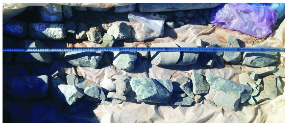
图4 双管单动取心筒岩心照片
