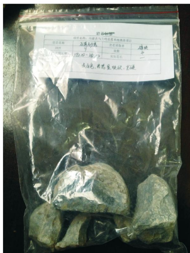
图3 单管取心筒岩心照片
