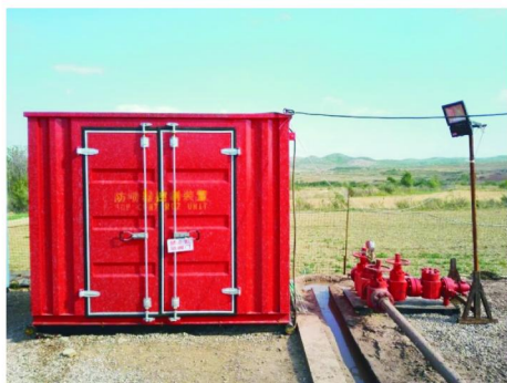
图4 远程控制台及压井管汇
