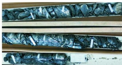
图2 现场取出的破碎地层岩心
