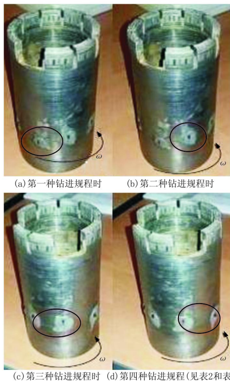
图7 不同钻进规程时水口变化钻头的钻头体与孔壁的接触点
