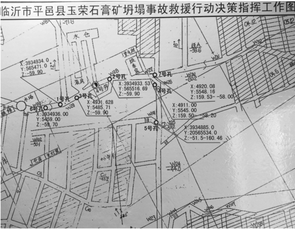
图 1 石膏矿矿体平面布置及救援钻孔布置
