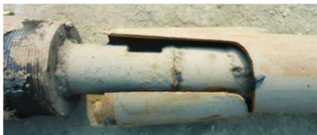
图4 用可退式捞矛处理上的事故钻杆
