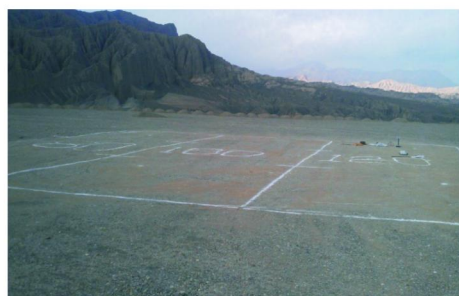
图 3 现场最大干密度试验场地
