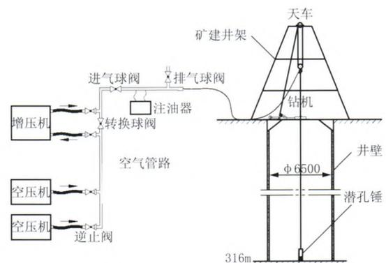
图4 空气钻进设备组合施工现场布置示意
