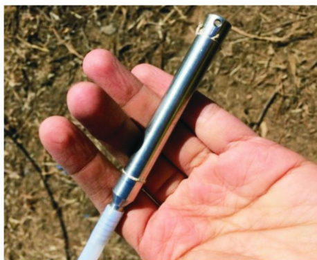
图4 外置式惯性泵泵头
