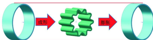
图3 膨胀波纹管变形膨胀过程
