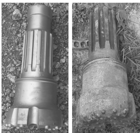
图 1 新锤头与断裂锤头对比
