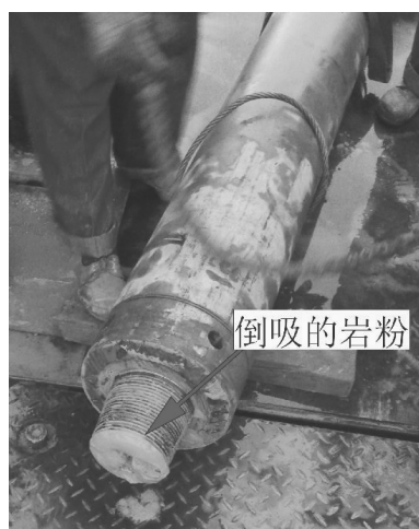
图 4 岩粉倒吸堵塞潜孔锤
