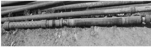
图3 K341 扩张式水力封隔器
