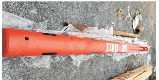
图 2 DXQ210/H 型管内液压悬挂式导斜器
