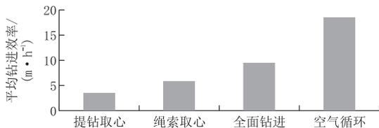
图 1 覆盖区填图中不同钻进工艺平均钻进效率对比
