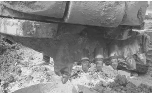
图 3 改进后钻斗底部的结构形式
