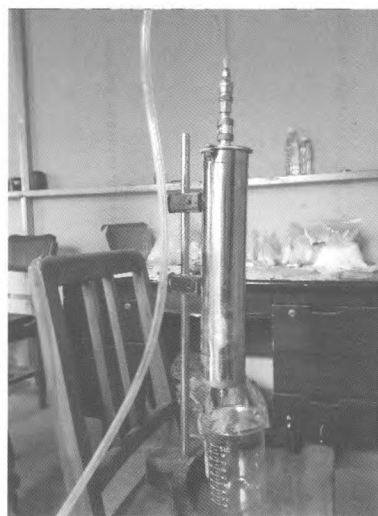
图3 模拟堵漏测试仪
