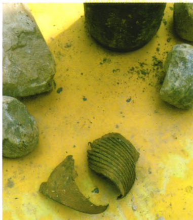
图 3 钻遇的岩心管及孔偏后取出的岩心
