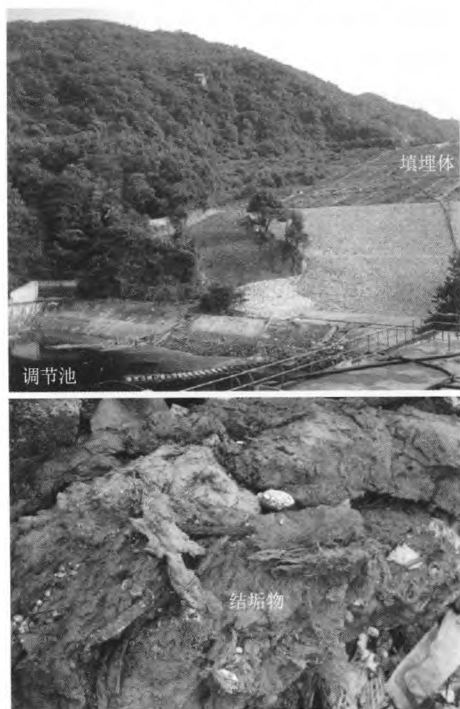
图 1 国内某垃圾填埋体及结垢物
