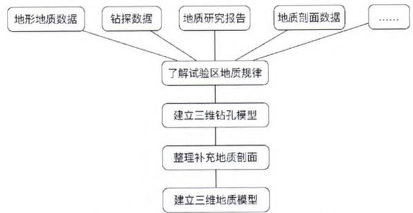
图 1 基于钻孔数据的三维地质建模技术路线
