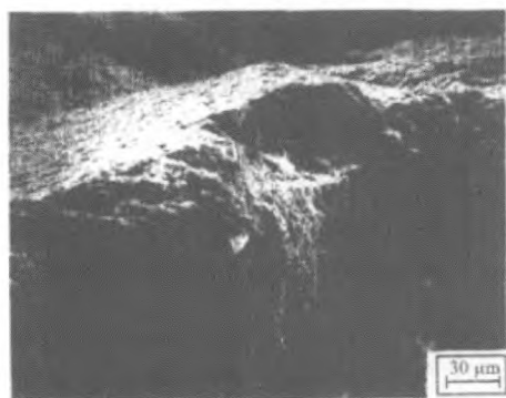
(b) 胎体磨损情况下金刚石颗粒突出
