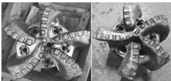
(a) 试验井段所用钻头 (b) 对比井段所用钻头 图 4 试验井段所用钻头与对比井段所用钻头出井外观
