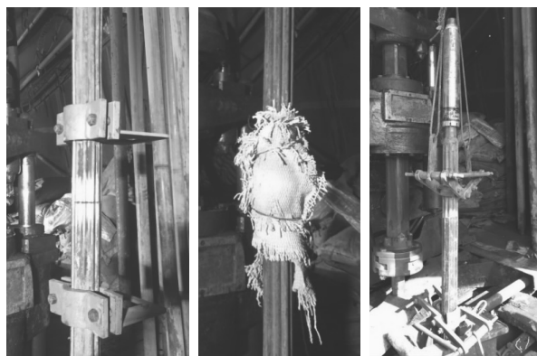
图3 膨胀波纹管对接、保养及下入
