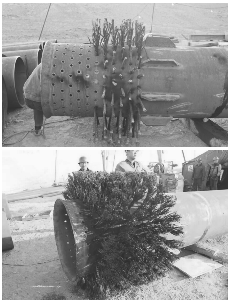
图 2 人工柔性井底实物
