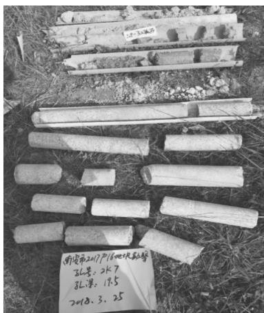
图 4 ZK-7 孔取出的岩(土)心样
