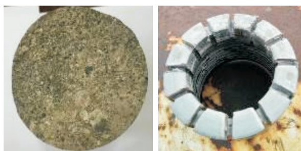
图 2 ZK-2 孔岩样和普通钻头出井照片
