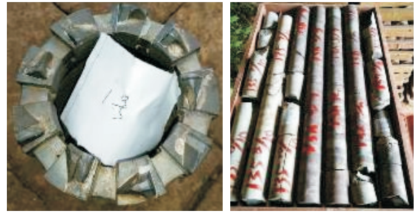
图 10 ZK-1 孔现场钻头及岩样图片
