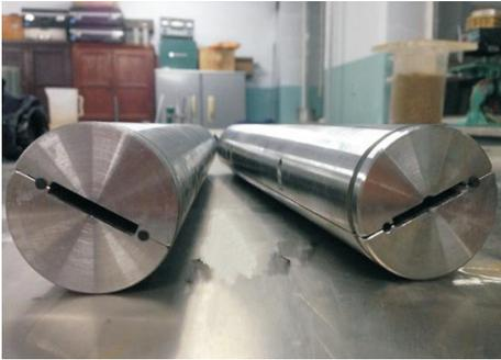
图5 堵漏试验仪的物理模块
