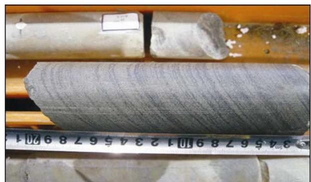
图 2 鸡 D7 井岩心中双粘土构造
