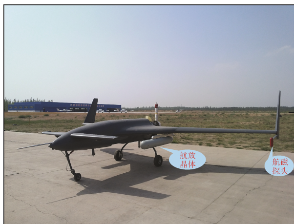
图 1 彩虹 3 无人机改装航空物探(磁/放)综合测量系统 Fig. 1 The modified Rainbow-3 UAVs integrated airborne geophysical (magnetic and gamma-ray) system
