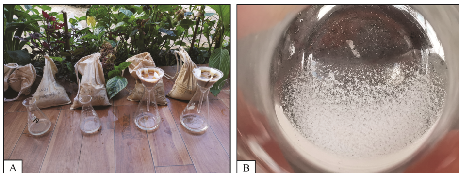
图 6 野外驻地快速分析判离子吸附型稀土矿：雪花状沉淀(原照片)
