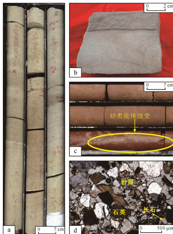
a, b—灰色含铀砂岩(ZD01, 1 415.1 m); c—烃类流体沿裂缝蚀变形成的灰色砂体; d—灰色含铀砂岩镜下特征。
