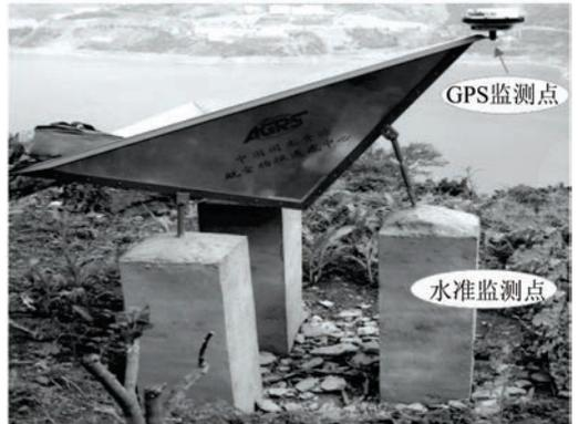
图 3 三角锥形反射体及水准和 GPS 测量点位
