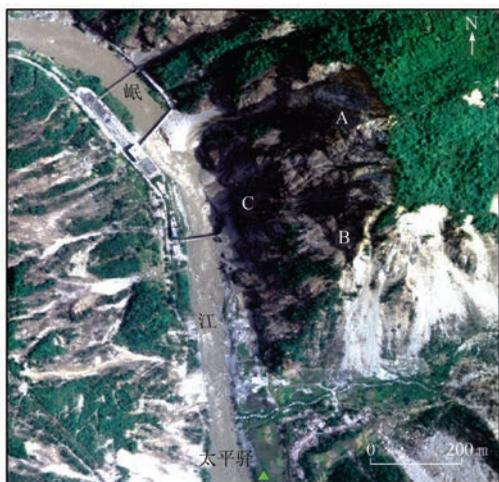
A: 有固定沟槽的崩滑体; B: 无固定沟槽的崩滑体; C: 岸坡崩滑
