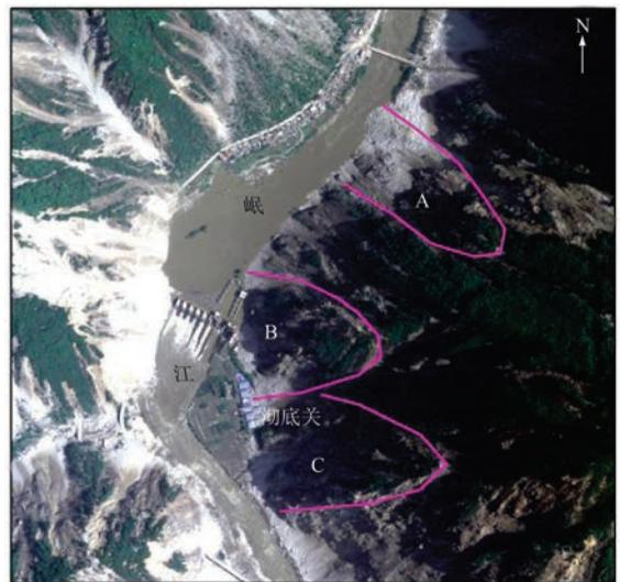
图 7 沱底关附近岷江东岸 2008 年汶川地震诱发的潜在滑坡群(A, B 和 C)
