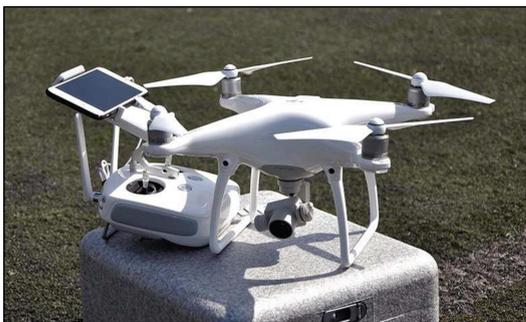
图 1 Phantom 4 无人机及地面控制系统
