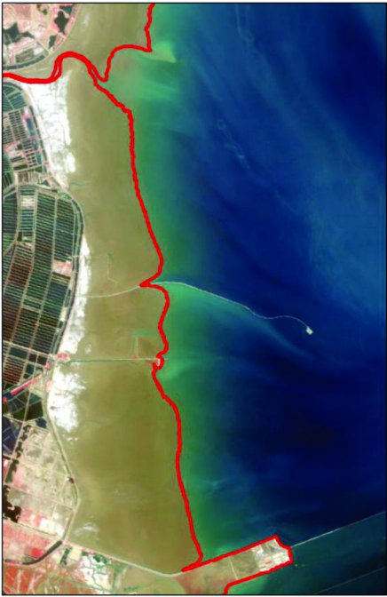
图 4 基于 NDWI 阈值分割的水边线提取结果 Fig. 4 Waterline extraction result based on NDWI threshold segmentation
