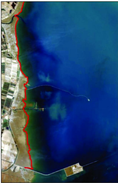
图 7 基于改进分水岭的水边线提取结果
