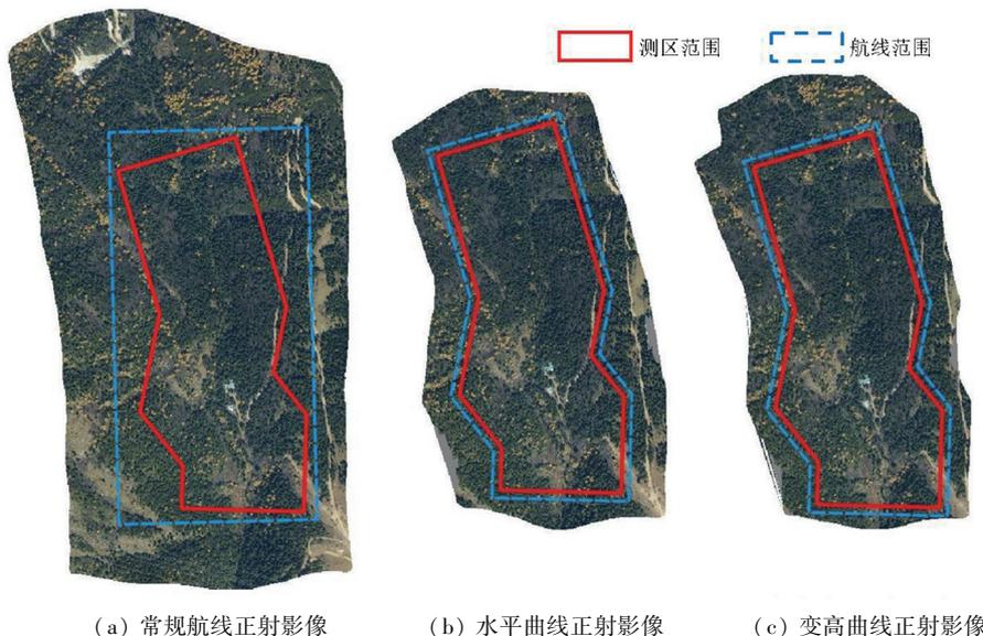
图 8 不同航线采集正射影像成果
