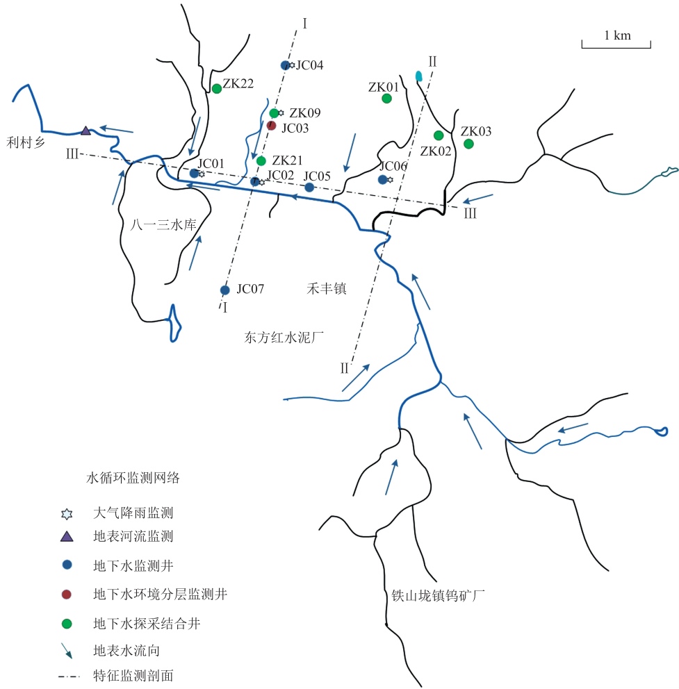
图 5 禾丰盆地水循环监测网络工作部署图
