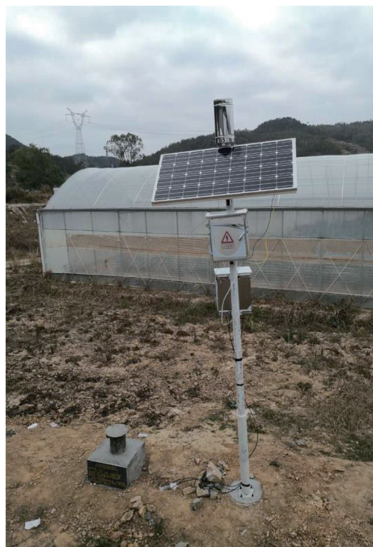
图7 禾丰盆地大气降水监测站
