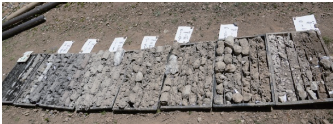
图 10 钻孔揭露滑坡土、滑带土体岩心特征
