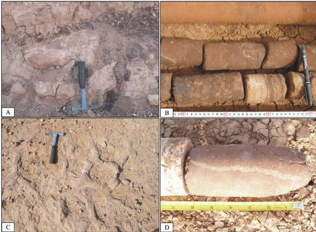
图 6 特吉达矿床热流体蚀变的露头、岩芯特征
